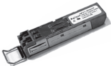
图3-13 千兆 SFP 光模块外观示意图
